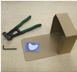
ガラスニッパー、ガラス、型紙、そして空き箱を用意します。このガラスニッパーには袋が付きません。ガラスが飛び散らないように、箱を画像のような位置に置いて作業してください。
