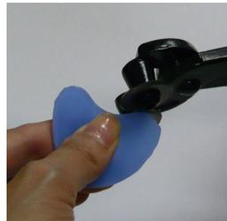
インカーブ(えぐり)部分は、少しずつ削っていきます。この型紙にあるような浅いインカーブでしたら、問題なく切れますが、深いインカーブは、ルーターなどで削ってください。
